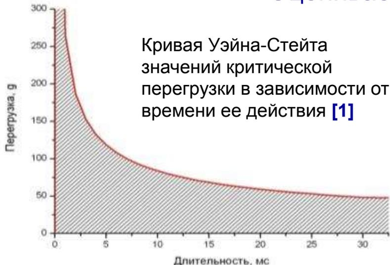
Кривая Уэйна-Стейта значений критической перегрузки в зависимости от времени ее действия [1]
