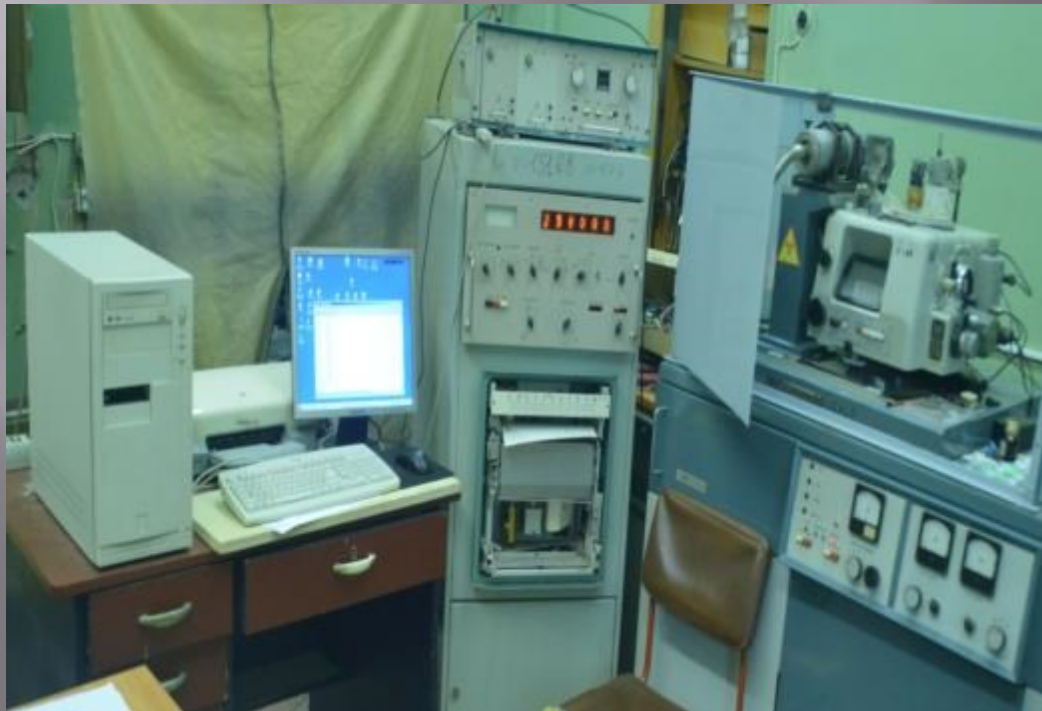
Установка ДРОН-2, на которой проводился эксперимент.
