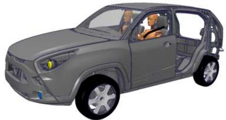
Модель, предназначенная для проведения виртуального краш-теста и оценки пассивной безопасности
