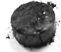
Образец, полученный холодным пресованием.
