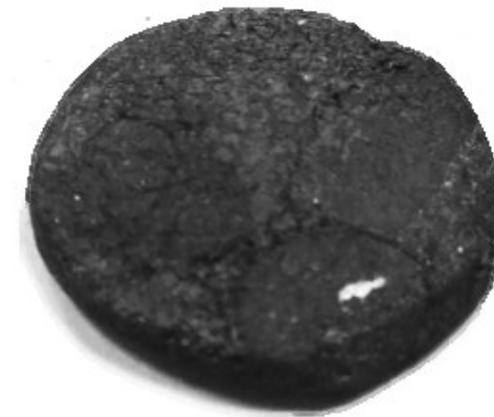
Образец, полученный горячим вакуумным спеканием.
