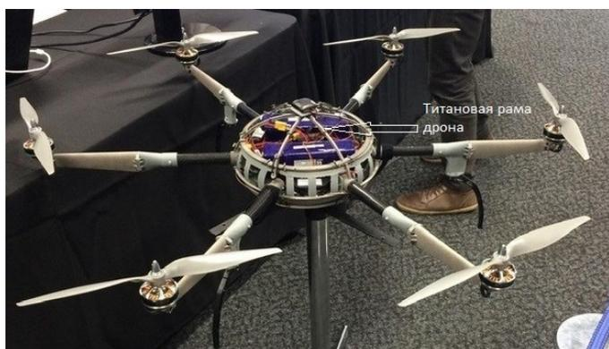
*Рисунок 1-14. Противопожарный гексакоптер*
