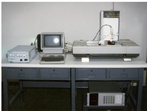
*Рисунок 1-4. «Установка для стереолитографии» Чарльза Халла*
