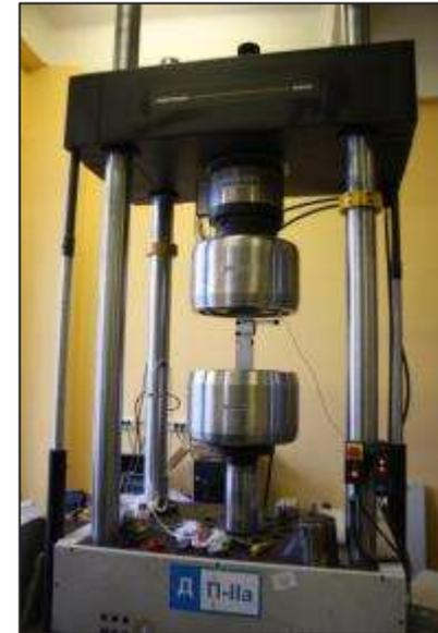
Гидравлическая разрывная машина Instron 8808
