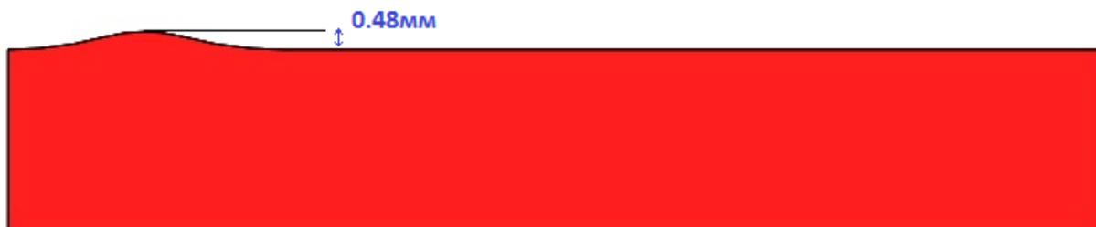
Рис. 3.17. Модель пластины, полученной в результате печати при движении глайдера из неизменного исходного положения
