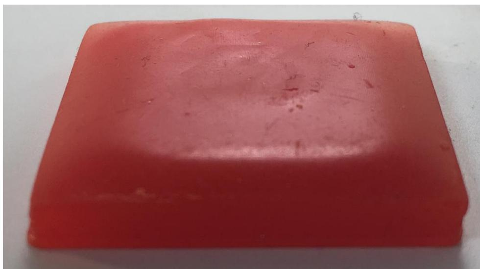
Рис. 3.12. Модель пластины, напечатанная без использования глайдера
