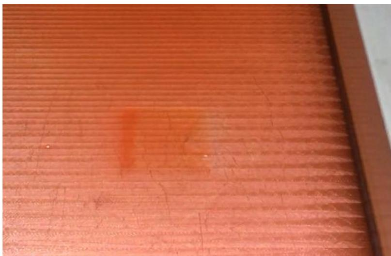
Рис. 2.5 – Излишки полимера вдоль левого края пластины
