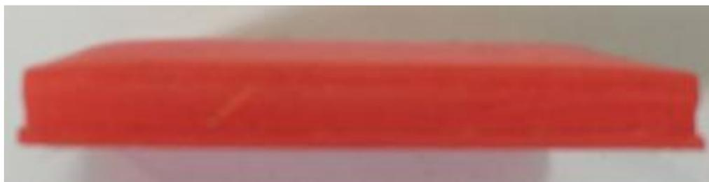
Рис. 3.12. Модель пластины, напечатанная без использования глайдера. Вид сбоку
