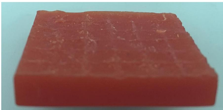
Рис. 3.9. Напечатанная модель пластины после удаления поддержек (эксп. №3)
