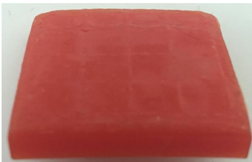
Рис. 3.6. Напечатанная модель пластины после удаления поддержек (эксп. №2)
