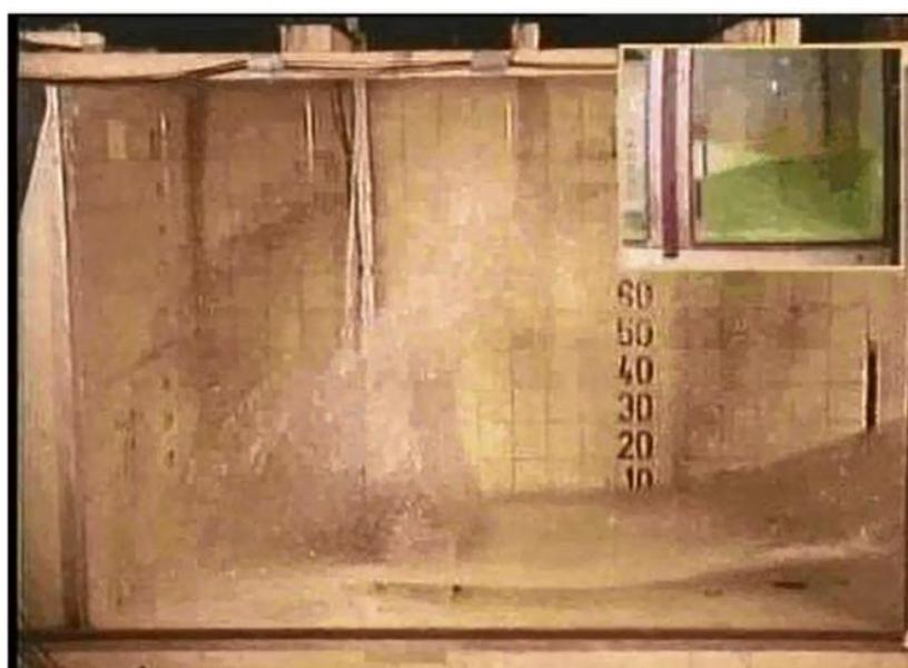
Рис 5.6. Распределение воды в контейнере в момент времени  $t = 0.6c$  (эксперимент)
