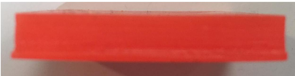
Рис. 3.19. Пластина, напечатанная при движении глайдера с переменным исходным положением. Вид сбоку
