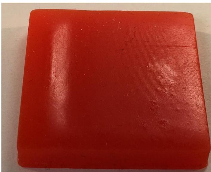
Рис. 3.15. Пластина, напечатанная при движении глайдера из неизменного исходного положения.
