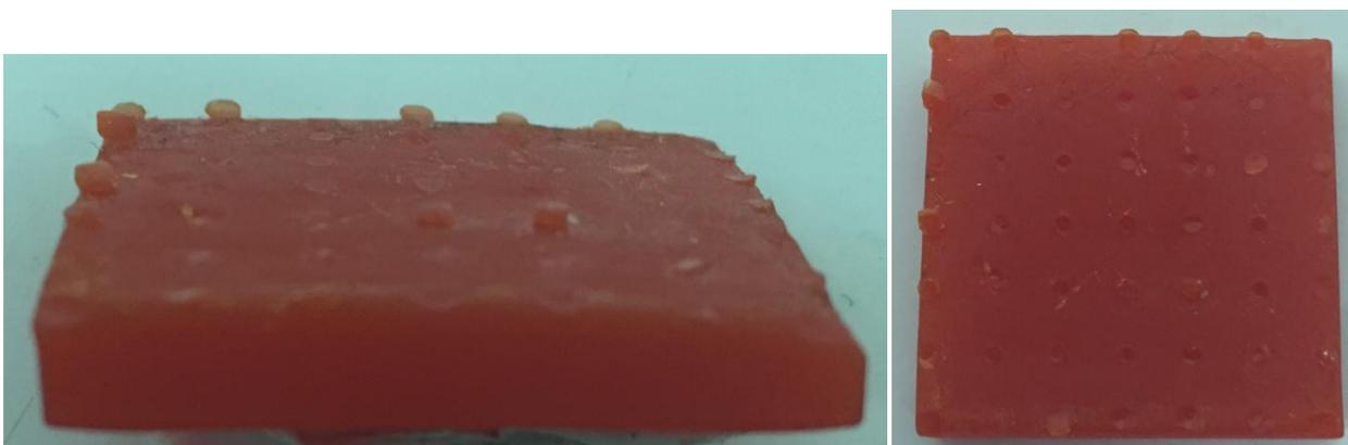
Рис. 3.3. Напечатанная модель пластины после удаления поддержек (эксп. №1)
