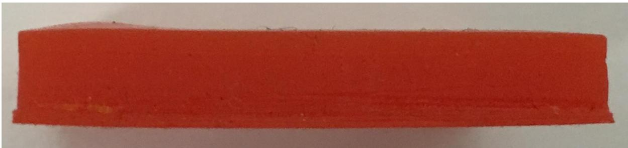
Рис. 3.14. Пластина, напечатанная при движении глайдера из неизменного исходного положения. Вид сбоку
