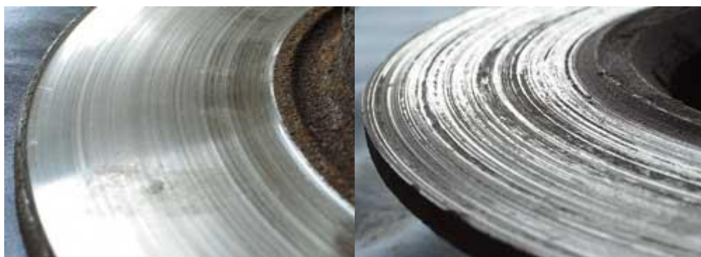
Рисунок 1.5 - Торможение некачественными колодками
