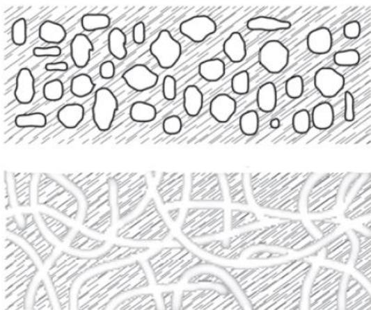
Рис. 1.7 Типы пористых материалов. Сверху – закрытые поры, ниже – открытые поры.
