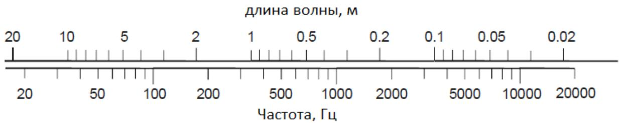
Рис. 1.3 Длина звуковой волны в зависимости от частоты
