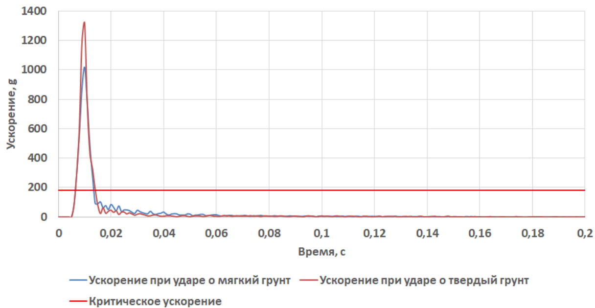
Рисунок 7.23 Ускорение аппаратуры при падении под углом 10^\circ
