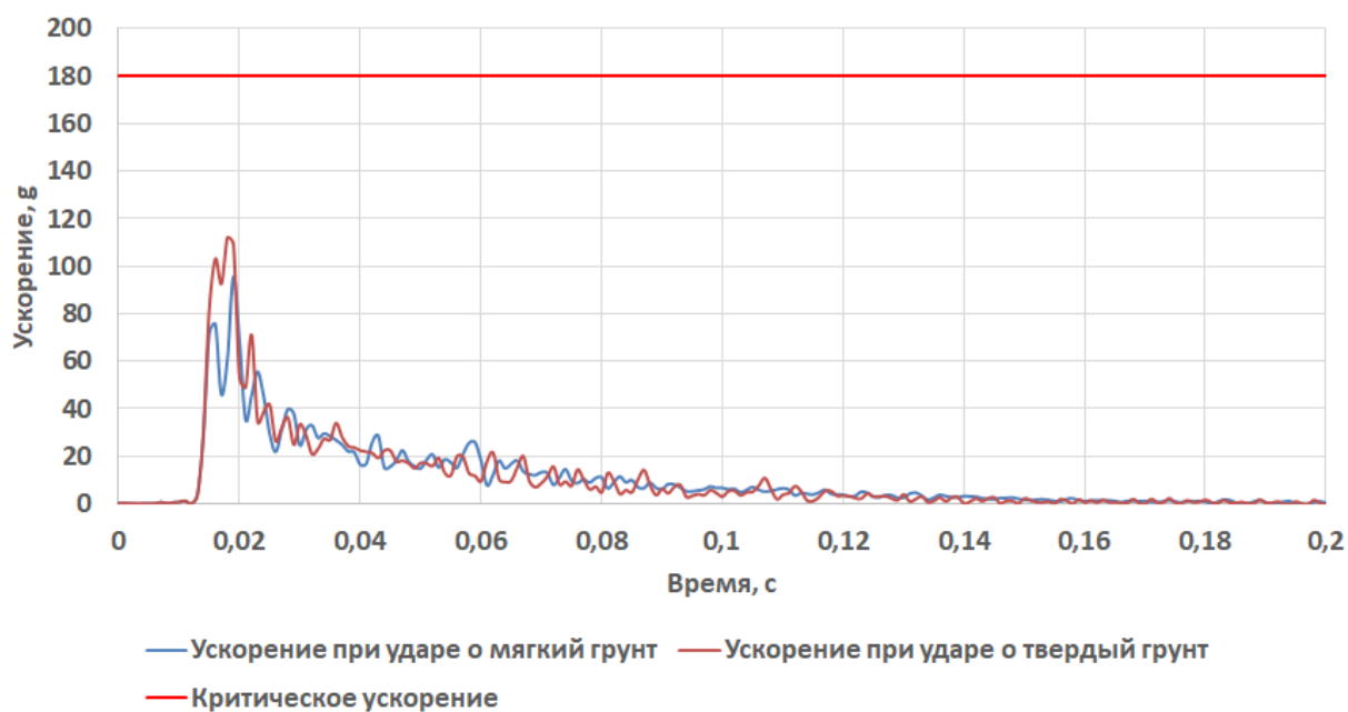
Рисунок 7.11 Ускорение аппаратуры при штатной посадке
