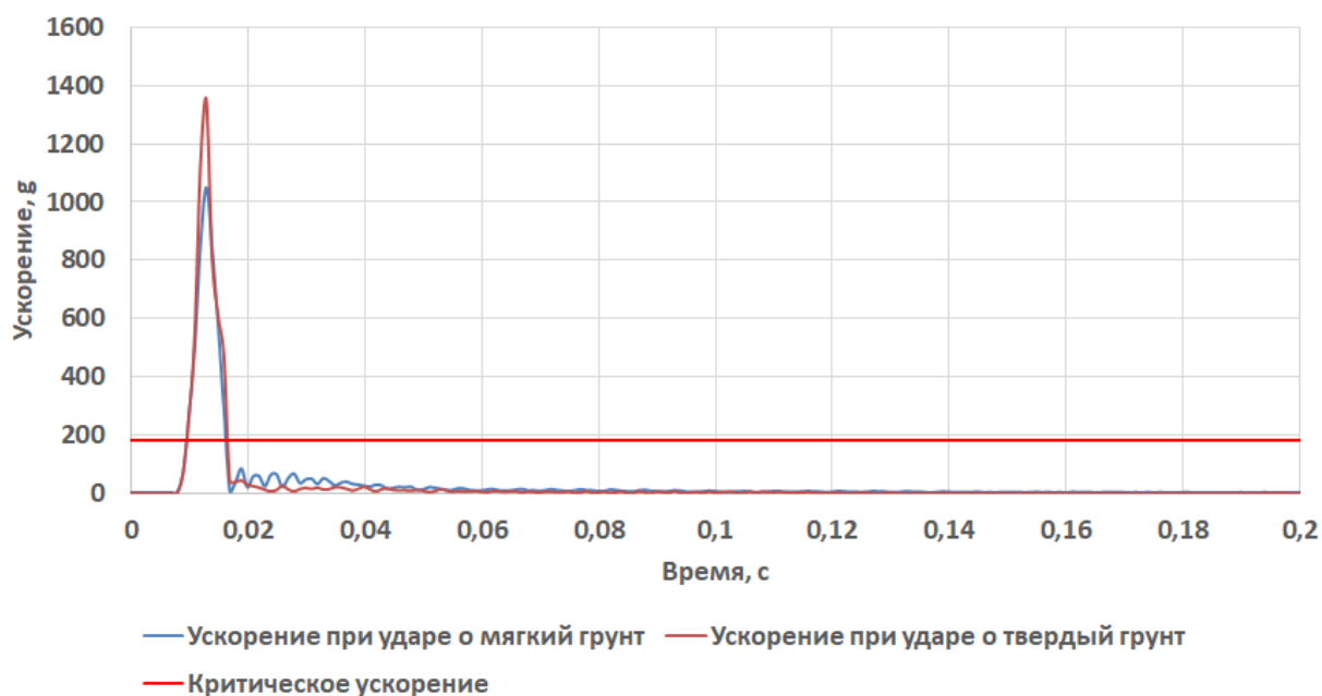
Рисунок 7.17 Ускорение аппаратуры при падении под углом 0^{\circ}
