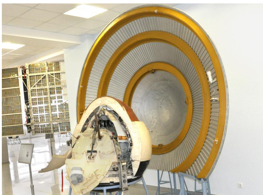
Рисунок 3.2 СА «Марс-6» с отсоединенным тормозным экраном
