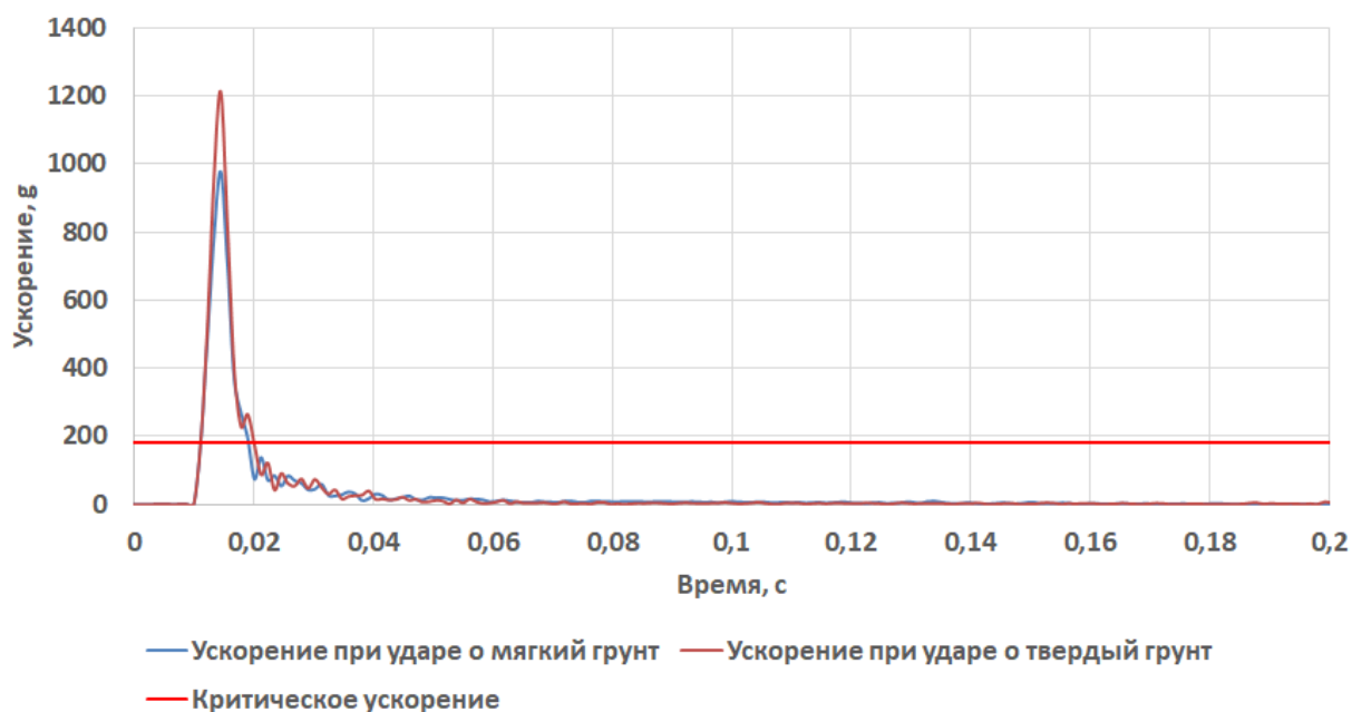
Рисунок 7.29 Ускорение аппаратуры при падении СА «Марс-6»
