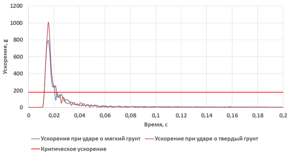
Рисунок 7.35 Ускорение аппаратуры при падении СА «Марс-6»
